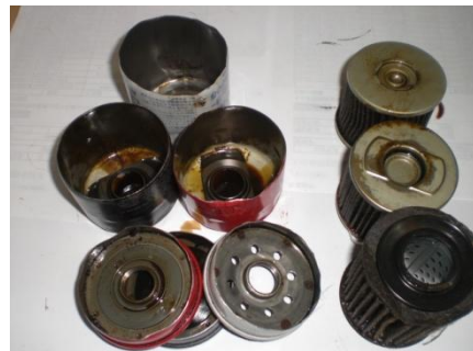
分解されたオイルフィルター
